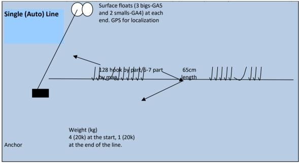
Figure 2a .- Single bottom auto longline diagram.
